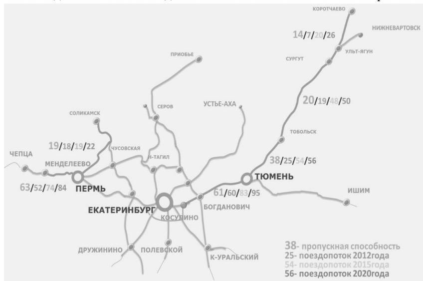
Рис. 1. Узкие места пропускания поездопотоков
